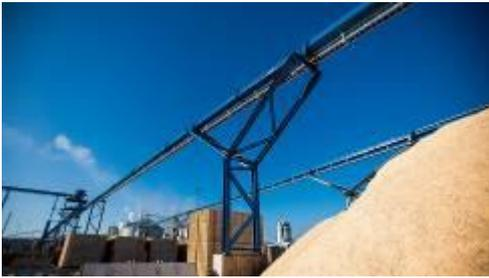
**Bild 1:** Im Bereich Holz und Biomasse wurden in den vergangenen Jahren zahlreiche Maschinen und Anlagen geliefert und in Betrieb genommen – wie diese Transportsysteme für Sägemehl und Hackschnitzel.
